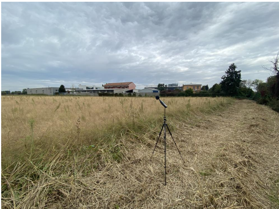
Foto 2: fonometro in R02, in prossimità dell'area oggetto della presente relazione, compatibile con il clima acustico presso i ricettori B
