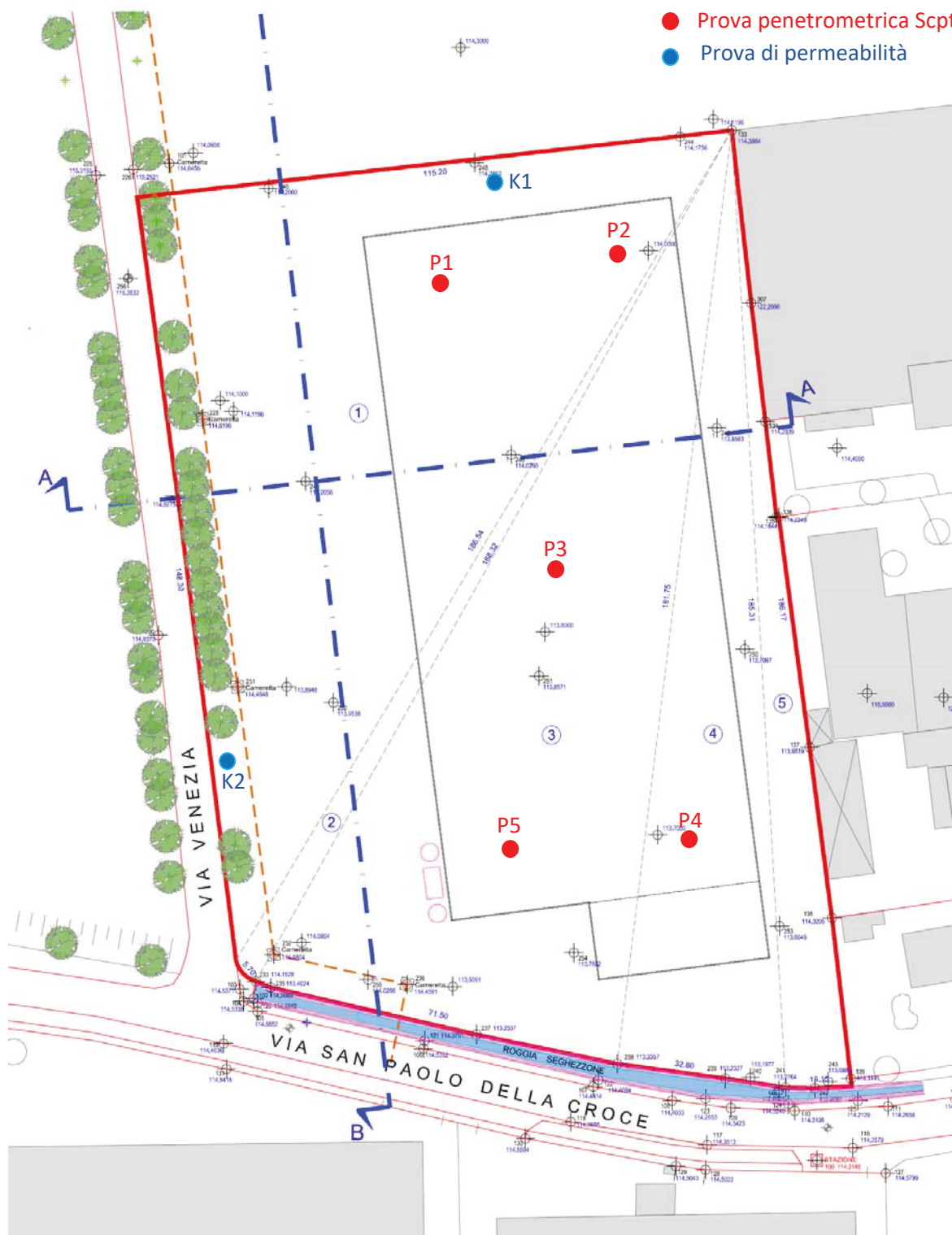
Fig. 10: ubicazione delle indagini eseguite su rilievo topografico
