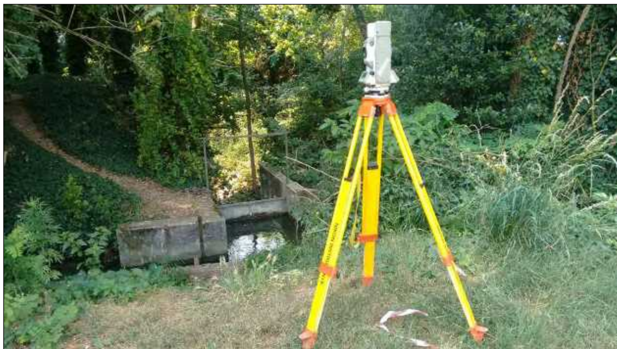
Figura 2 Rodano - Roadello rilievo manufatto di regolazione con stazione totale
