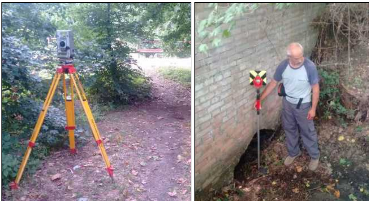
Figura 4 Peschiera - Fiorano rilievo asta con stazione totale
