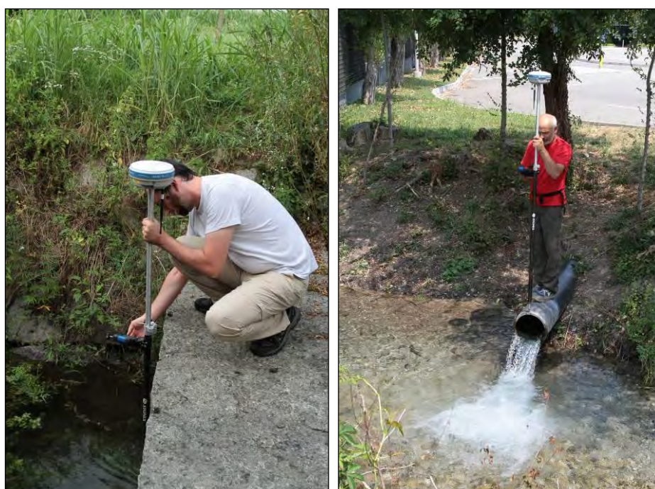
Figura 5 Liscate Albanedo rilievo quota briglia e Peschiera Trebianella rilievo tubo
